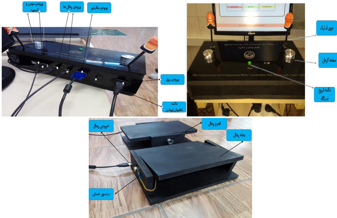
شکل ۵. بخش های سخت افزاری دستگاه هماهنگی حرکتی
