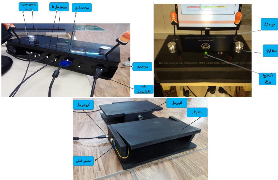
شکل ۵. بخش های سخت افزاری دستگاه هماهنگی حرکتی
