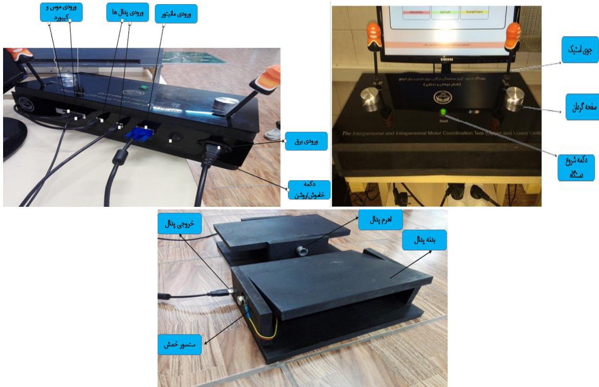
شکل ۵. بخش های سخت افزاری دستگاه هماهنگی حرکتی
